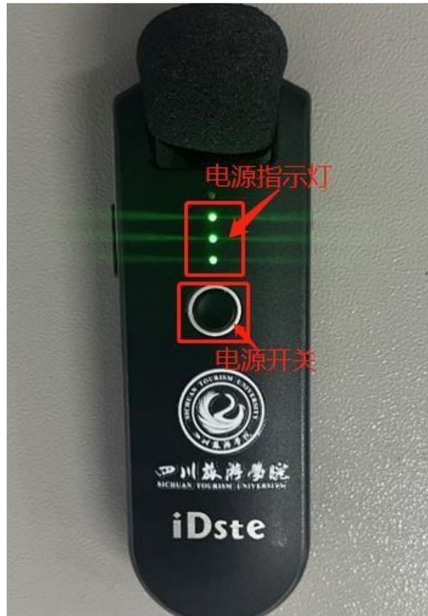
第二步：**检查无线扩音设备和教室的无线接收设备是否对频**。如果对频指示灯亮红灯，代表此时无线话筒没有和接收设备对上频，若没有对上频，无线话筒就不能扩声。对频指示灯为绿色常亮（或者绿色闪烁），代表对频状态正常。若没有对上频，则关闭无线话筒的电源后重新打开即可（有效对频范围为距离讲台 2 米范围内，对频成功后有效接收距离为以讲台为半径 30 米范围以内，开机后对频时间约在 5 秒钟内完成）。
